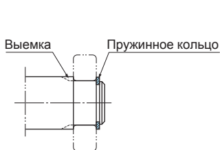
(а) Пружинное кольцо и заплечик с выемкой
